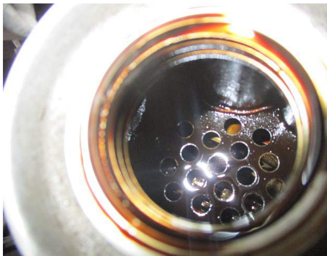
Catatan: Oli mesin berkerak
